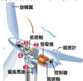
圖 3. 風力發電機零件名稱
